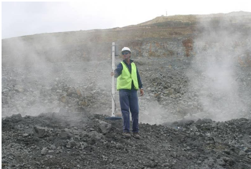
Figura 4. Detecção dos monitores BMM na pilha desmontada logo após o fogo
