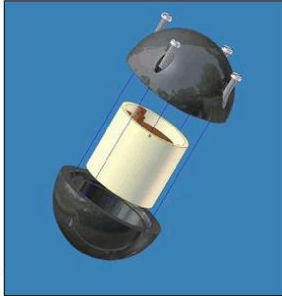
Figura 2. Projeção interna do transmissor BMM e seu encapsulamento plástico
